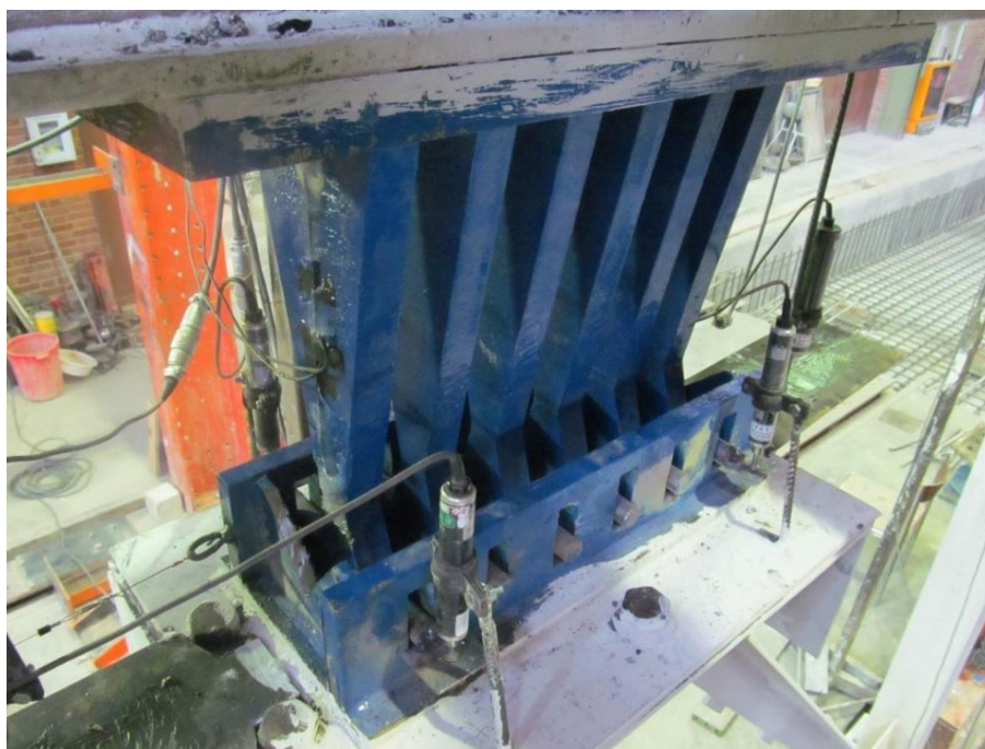
شکل شماره ۱ - میراگر فلزی پره مثلثی یا تدس که یکی از انواع میراگرهای غیرفعال اتلاف انرژی زلزله می‌باشد.
