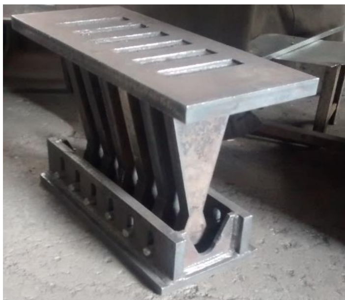
شکل شماره ۱ - تصویر میراگر فلزی پره مثلی یا تدس که یکی از انواع میراگرهای غیرفعال اتلاف انرژی زلزله می‌باشد
