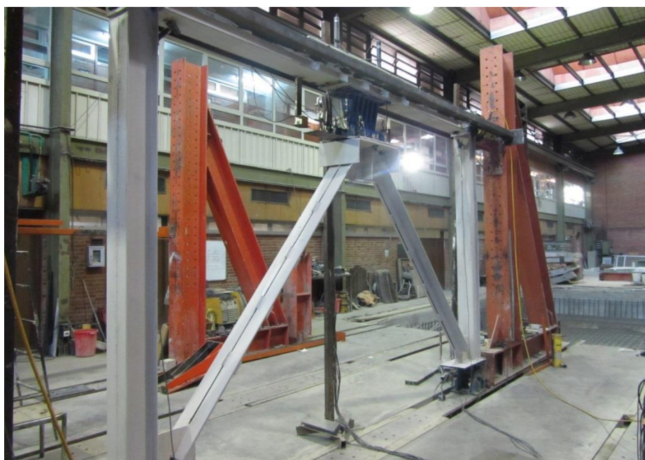
شکل شماره ۳ - نحوه ی نصب میراگر تدس در قاب ساختمانی در آزمایشگاه مرکز تحقیقات راه مسکن و شهرسازی
