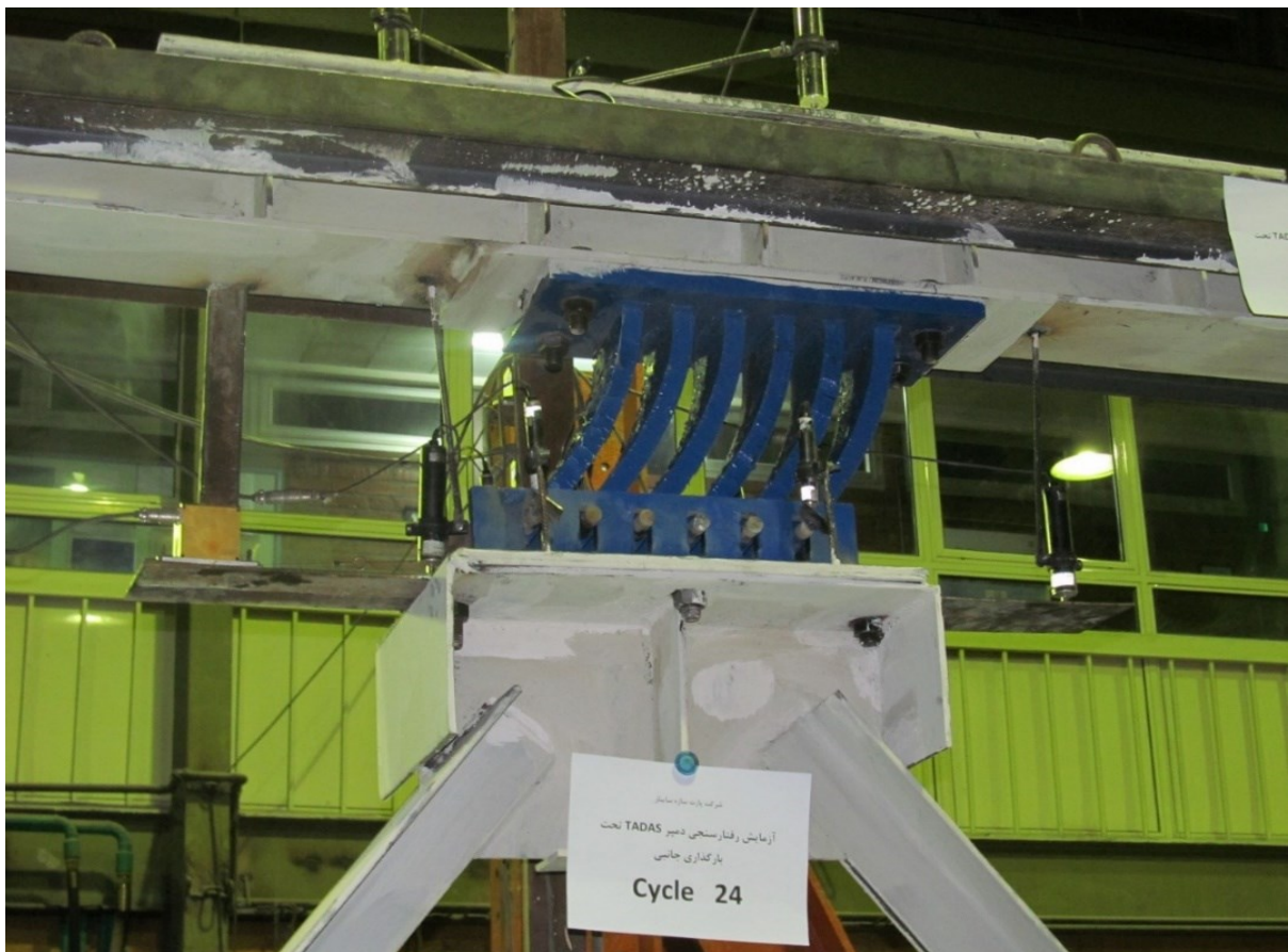
شکل تغییر شکل یافته میراگر در آخرین چرخه آزمایش
