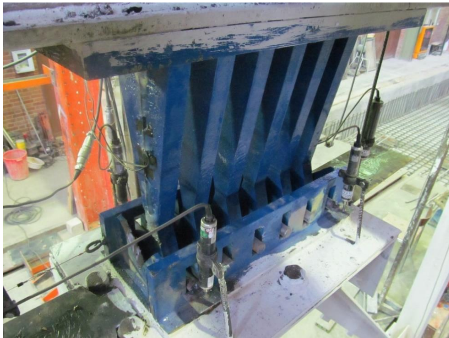
شکل شماره ۱ - تصویر میراگر فلزی پره مثلثی یا تدس که یکی از انواع میراگرهای غیرفعال اتلاف انرژی زلزله می‌باشد.
