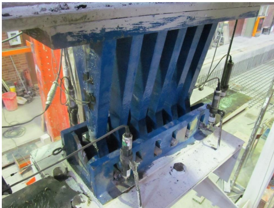
شکل شماره ۱- میراگر فلزی پره مثلی یا تدس که یکی از انواع میراگرهای غیرفعال اتلاف انرژی زلزله می‌باشد.
