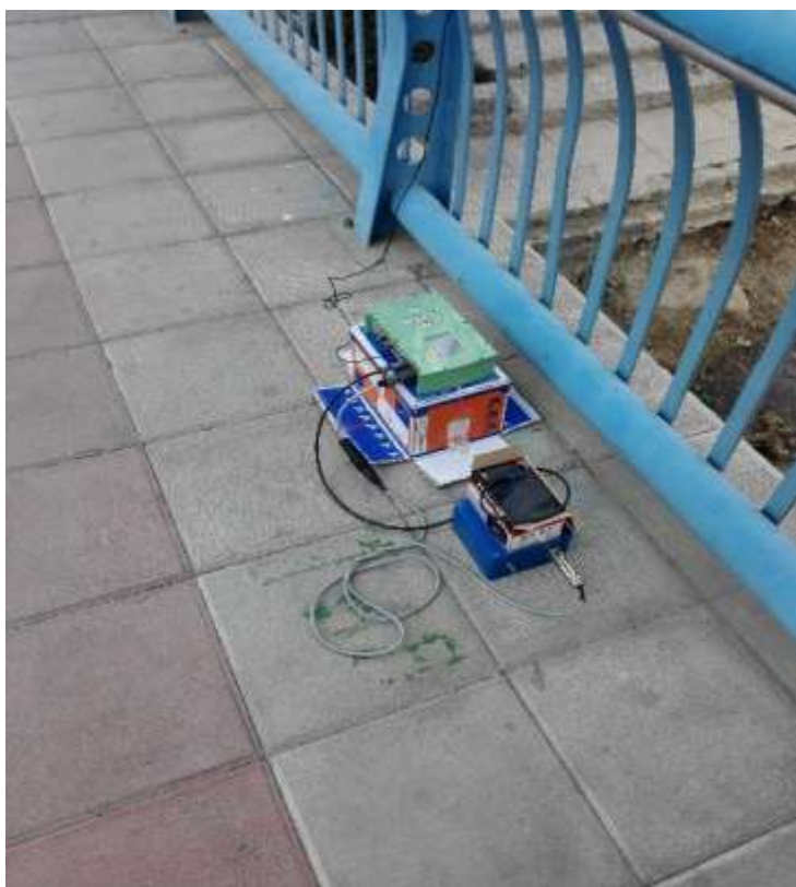
شکل شماره ۴: استقرار حسگر شتاب ۵ (آزمایش ۳) - پل بزرگمهر
