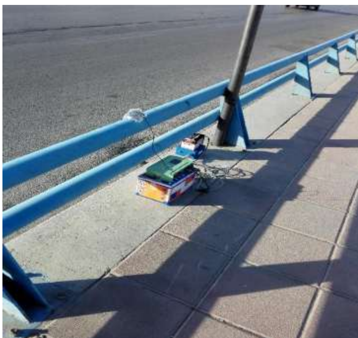
شکل شماره ۴: استقرار حسگر شتاب ۵ (آزمایش ۳) - پل بزرگمهر
