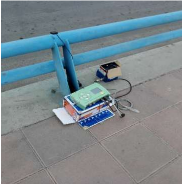
شکل شماره ۲: استقرار حسگر شتاب ۱ (آزمایش ۱) - پل بزرگمهر
