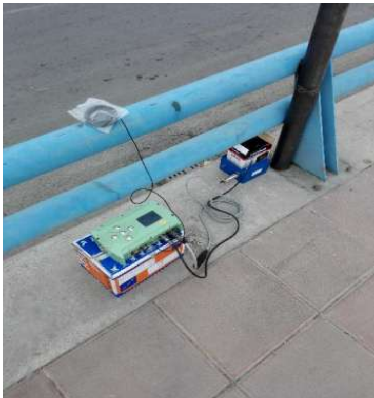
شکل شماره ۲: استقرار حسگر شتاب ۱ (آزمایش ۱) - پل بزرگمهر
