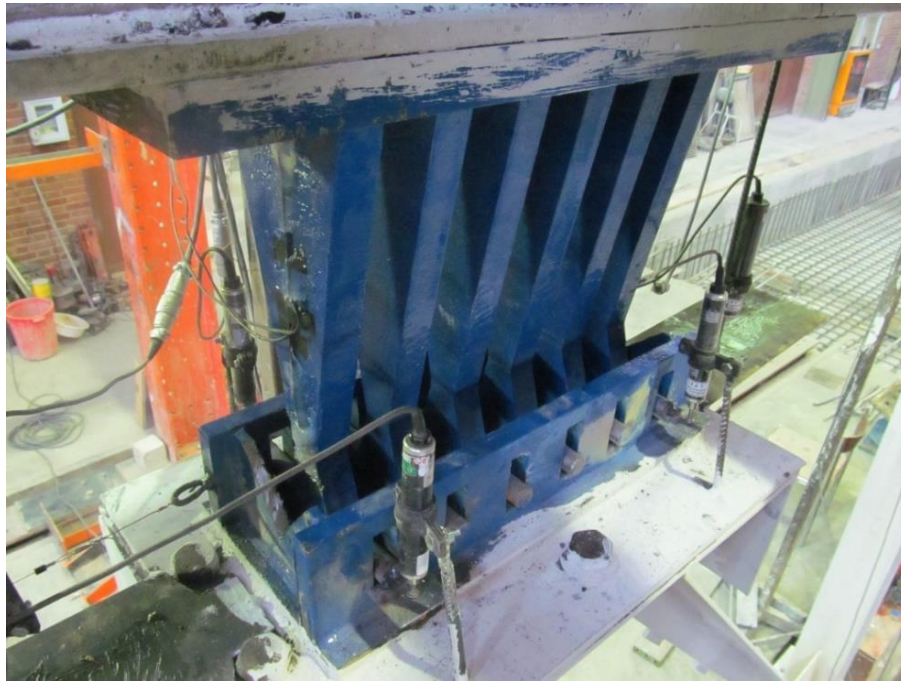
شکل شماره ۱- میراگر فلزی پره مثلثی یا تدس که یکی از انواع میراگرهای غیرفعال اتلاف انرژی زلزله می‌باشد.
