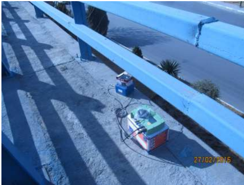
شکل شماره ۶: استقرار حسگر شتاب ۱ (آزمایش ۱) - پل چمران
