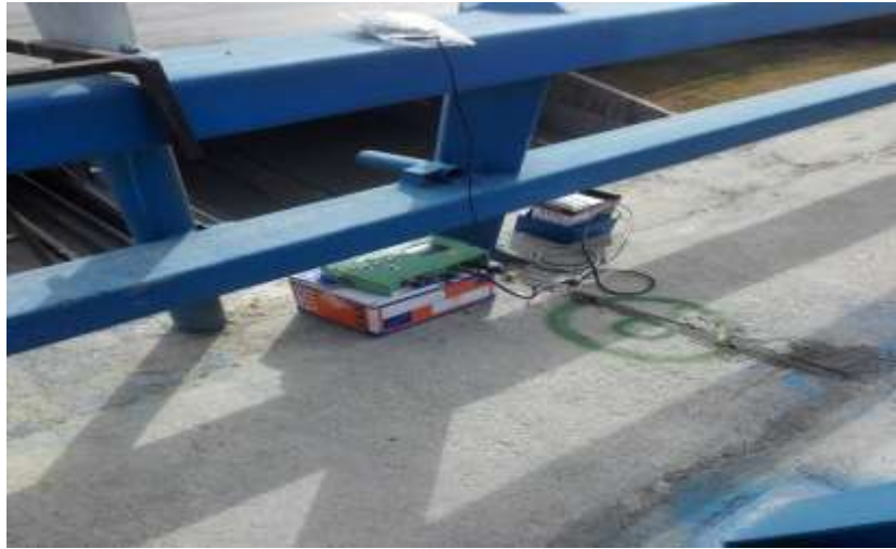
شکل شماره ۱۶: استقرار حسگر شتاب ۱ (آزمایش ۹) - پل چمران
