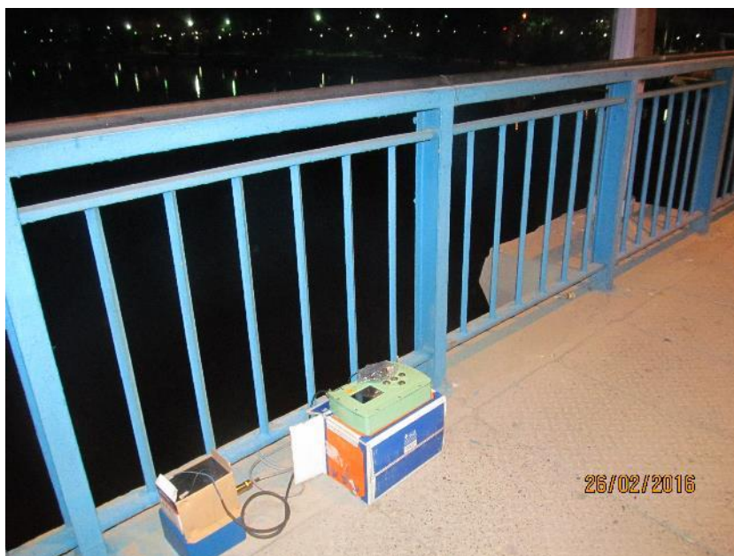
شکل شماره ۲۶: استقرار حسگر شتاب ۲ (آزمایش ۱۴) - پل فلزی
