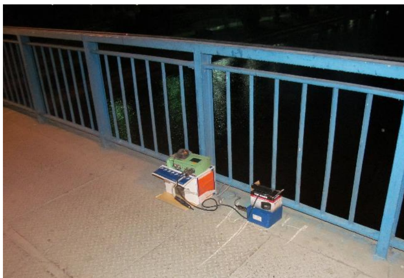
شکل شماره ۱۵: استقرار حسگر شتاب ۱ (آزمایش ۸) - پل فلزی
