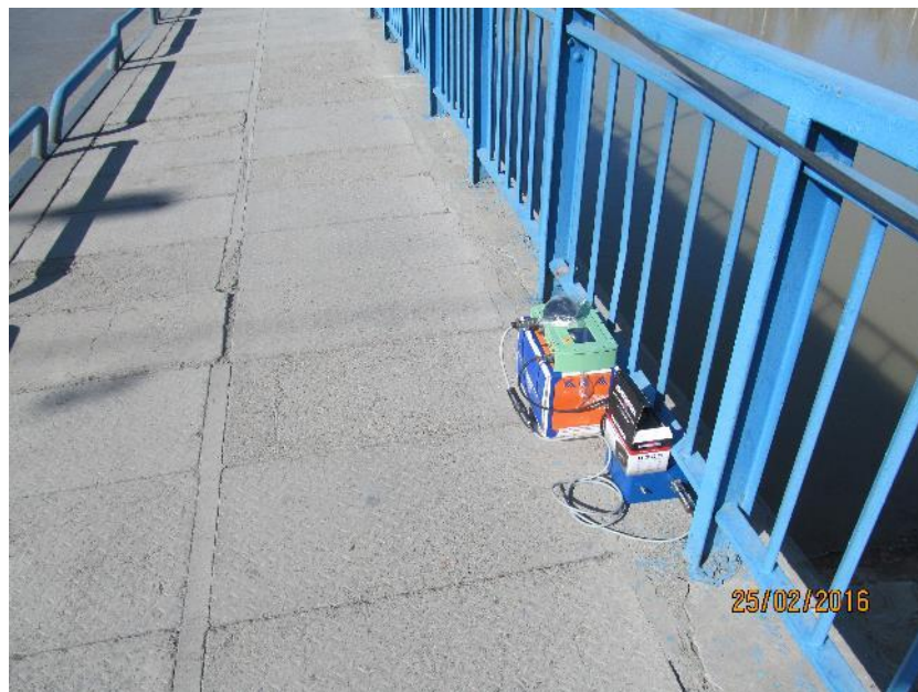
شکل شماره ۲۱: استقرار حسگر شتاب ۲ (آزمایش ۱۱) - پل فلزی
