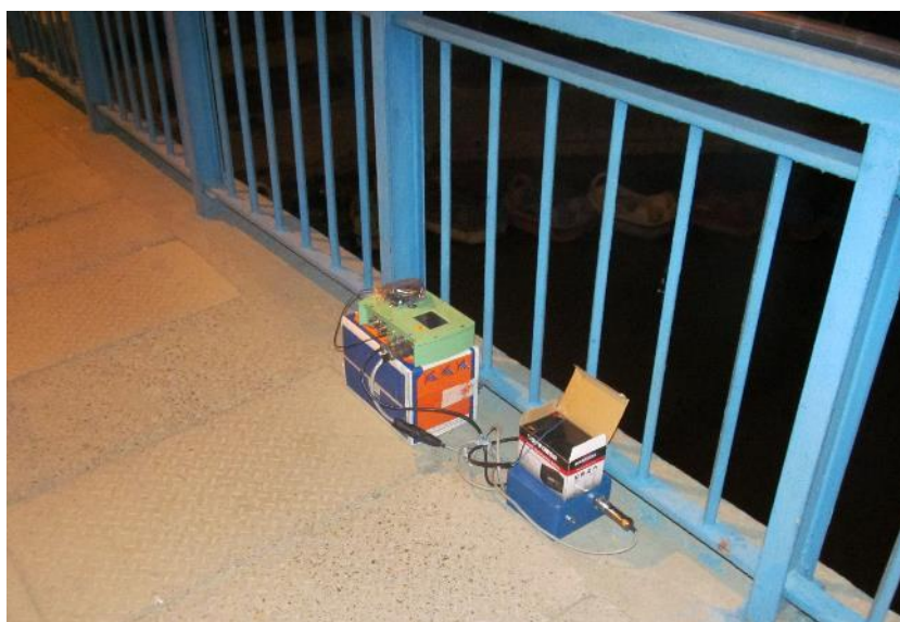
شکل شماره ۱۳: استقرار حسگر شتاب ۴ (آزمایش ۷) - پل فلزی
