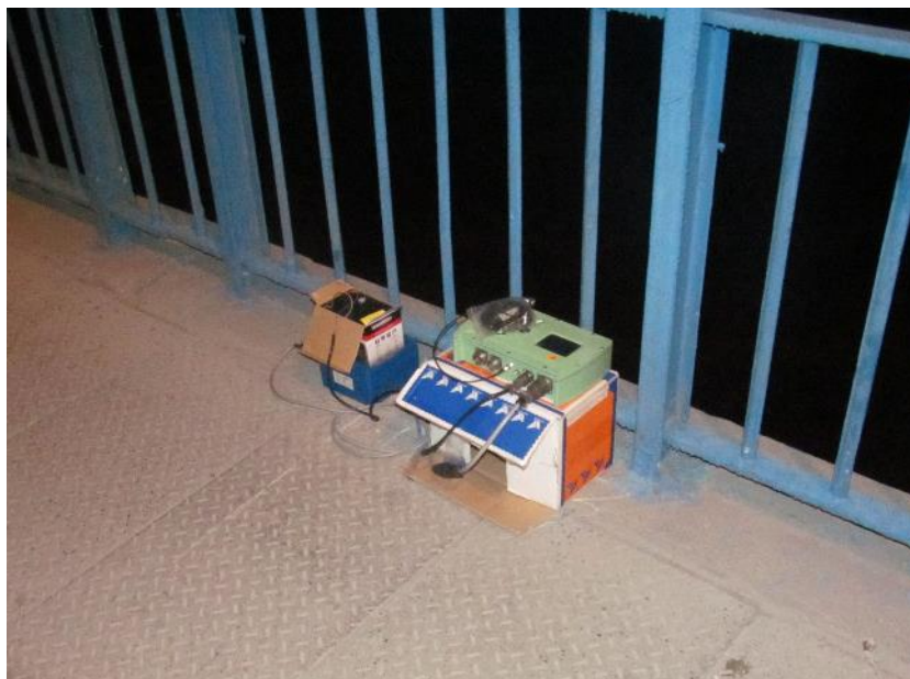
شکل شماره ۱۳: استقرار حسگر شتاب ۴ (آزمایش ۷) - پل فلزی
