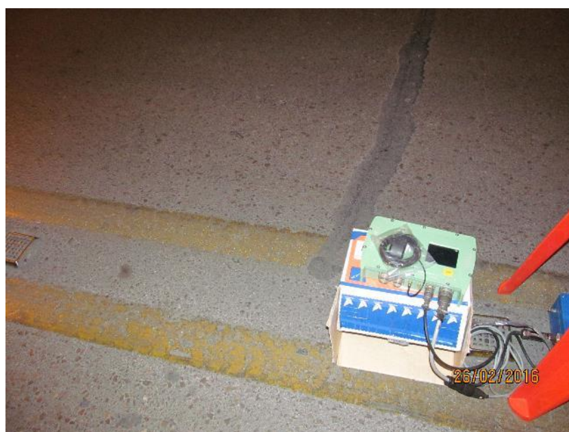
شکل شماره ۲۸: استقرار حسگر شتاب ۱ (آزمایش ۱۶) - پل فلزی
