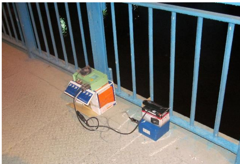
شکل شماره ۱۷: استقرار حسگر شتاب ۱ (آزمایش ۹) - پل فلزی
