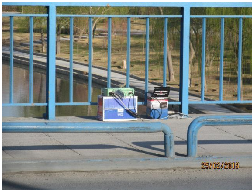
شکل شماره ۲۳: استقرار حسگر شتاب ۲ (آزمایش ۱۲) - پل فلزی
