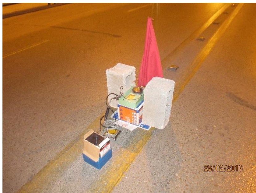
شکل شماره ۲۷: استقرار حسگر شتاب ۳ (آزمایش ۱۵) - پل فلزی
