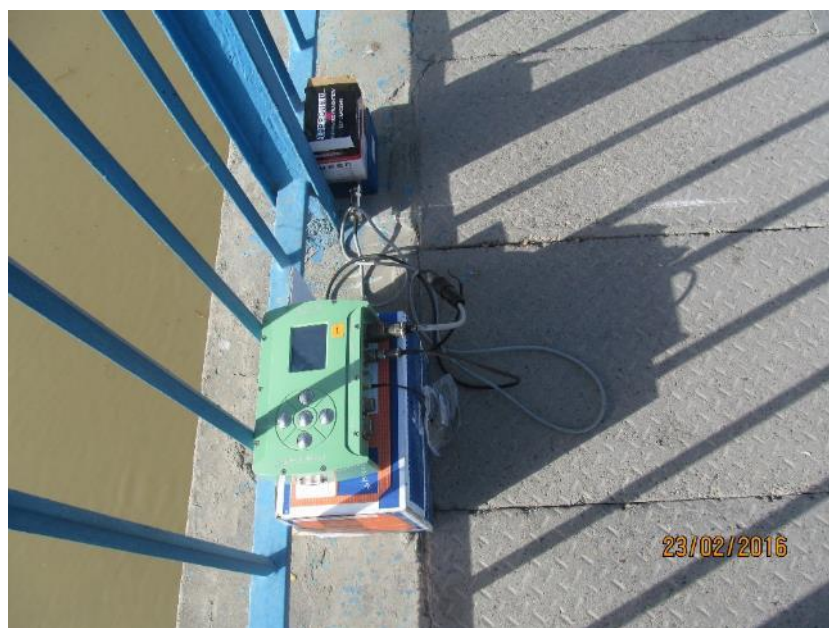
شکل شماره ۹: استقرار حسگر شتاب ۱ (آزمایش ۱) - پل فلزی
