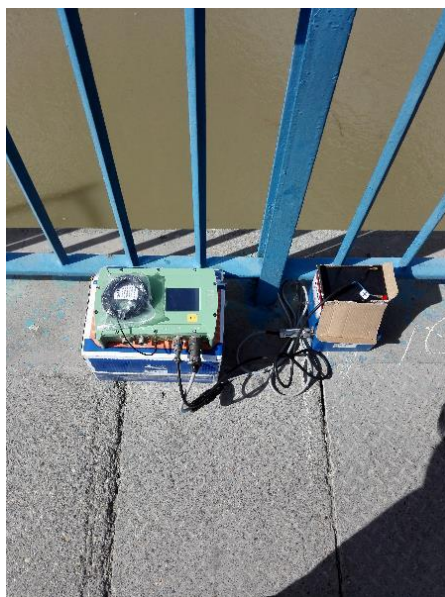
شکل شماره ۱۱: استقرار حسگر شتاب ۱ (آزمایش ۶) - پل فلزی
